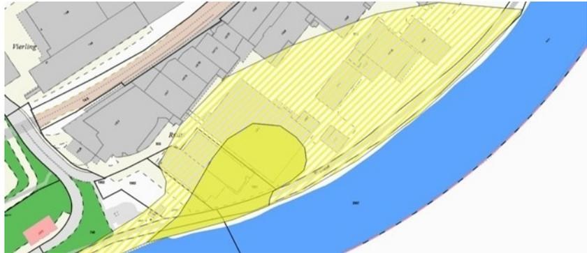
Mittels einer leichten Geländegestaltung (Wall/Damm) entlang des Rheinufers könnte mit wenig Aufwand eine zusätzliche Sicherheit erreicht werden. Ein Ausfall von Produktionsanlagen oder Schäden im Lagerbereich wäre für die IVF Hartmann mit grossen Nachteilen verbunden. Mit wenig Aufwand könnte dieses Restrisiko sinnvoll reduziert oder gar eliminiert werden. Hochwasserschutzmassnahmen innerhalb des Gewässerraumes sind zulässig und kompatibel mit dessen Nutzungsvorschriften.
