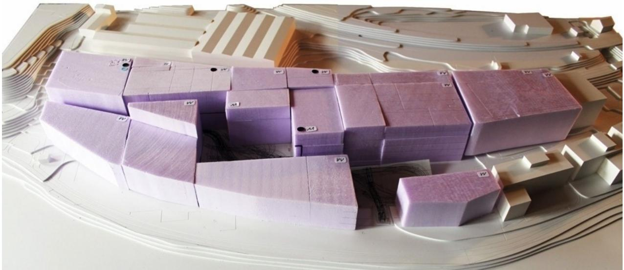
Modellbild "Vollvariante" mit maximal möglicher Ausnützung gemäss Bauordnung
