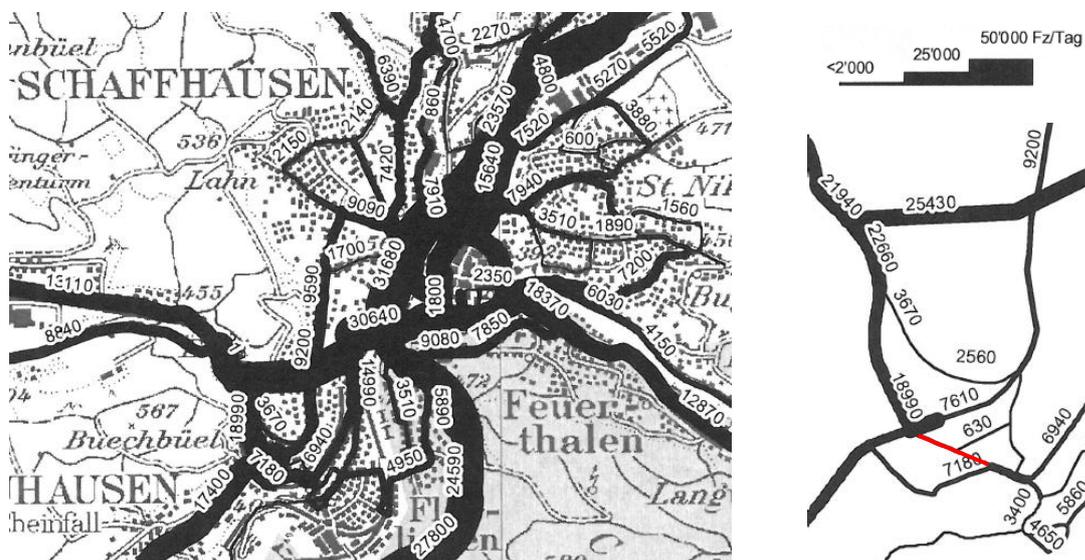
Abbildung 5: Querschnittsbelastung im DWV Prognose 2030 mit Galgenbucktunnel und flankierenden Massnahmen
